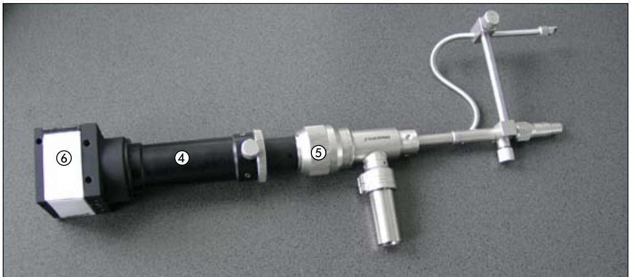
Оптический блок, окончательно смонтированный
